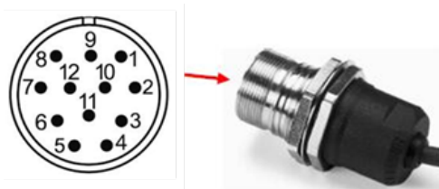
Vista base connettore maschio M23 lato encoder
