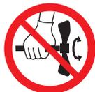
**Non effettuare la rotazione manuale della prolunga e del ventilatore con freno inserito o freno disinserito sotto carico.**
